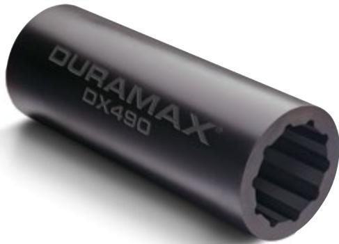
Los bujes para timón DX490 están fabricados a partir de un compuesto de caucho de nitrilo con un valor de dureza de 70 con un durómetro de tipo D (aproximadamente de la dureza de una bola de bolos). Están diseñados para resistir el duro "impacto" del sistema de dirección del buque. El DX490 tiene una gran rigidez que le confiere la máxima estabilidad dimensional a la vez que mantiene un grado de elasticidad necesaria para amortiguar las cargas de choque.
